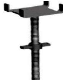
7 – Домкрат резьбовой служит для регулировки высоты и выравнивания верхней палубы через резьбовые опоры с гайкой. Воспринимает на себя всю нагрузку опалубки и передает ее на грунт через деревянные подкладки. L=750 мм
