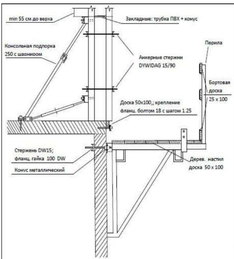
Рис.1. Кронштейн наружных стен
