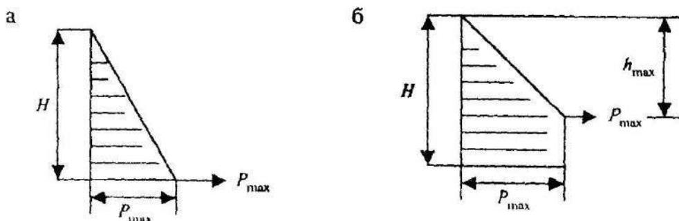
Рис.1 - Расчетные эпюры бокового давления бетонной смеси
