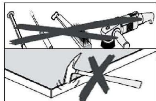
Запрещается ударять молотком, как по профилю каркаса щитов, так и по палубе опалубки.
