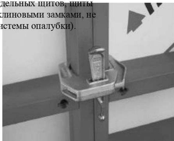
5-ти точкам замок позволяет производить стягивание и выравнивание одним ударом молотка. Одновременно осуществляется мгновенная автоматическая фиксация. При небольшом весе замка (2 кг), его можно устанавливать также, стоя на лестнице, одной рукой.
