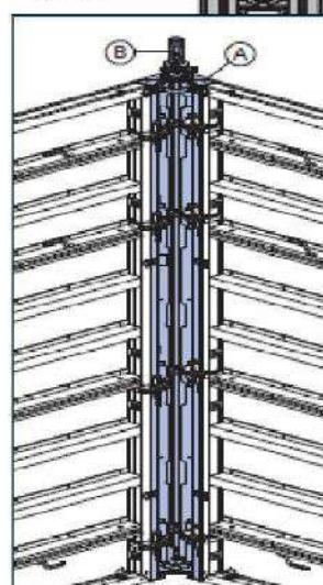
**Положение компенсаторов (подгоночный брус) во внутренней опалубке шахты:**
