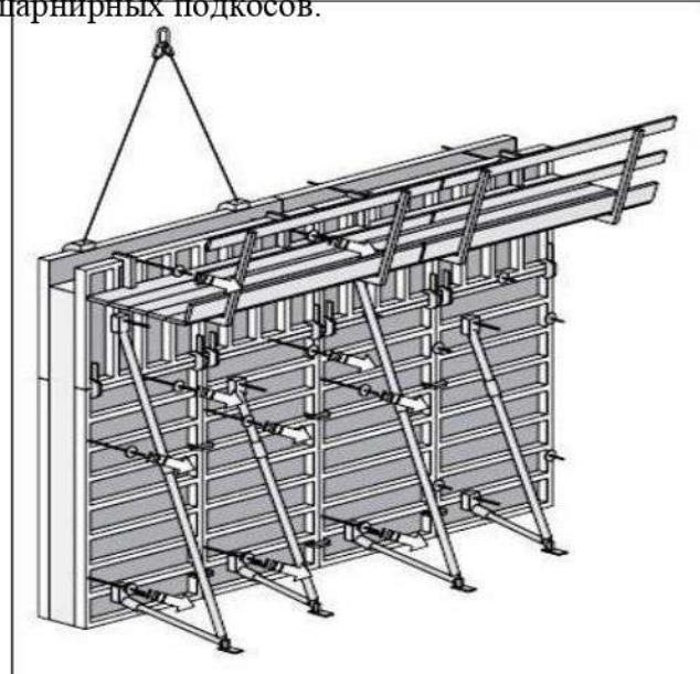
• Следует всегда следить, чтобы палуба щитов опалубки, при перемещении, не соприкасалась с поверхностью бетона!
